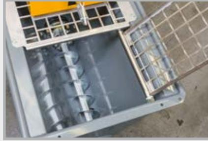
Grille de protection avec interrupteur de sécurité intégré, avec un grand angle d'ouverture pour offrir une accessibilité optimale lors de la maintenance et du nettoyage
